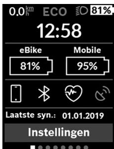
Op het statusscherm krijgt u naast de statusbalk de actuele tijd, de laadtoestand van alle accu's van uw eBike en de laadtoestand van uw smartphone-accu te zien, als de smartphone via Bluetooth® is verbonden. Daaronder worden evt. symbolen voor de aanduiding van een geactiveerde Bluetooth®-functie of een via Bluetooth® verbonden toestel (bijv. een hartslagmeter) afgebeeld.
