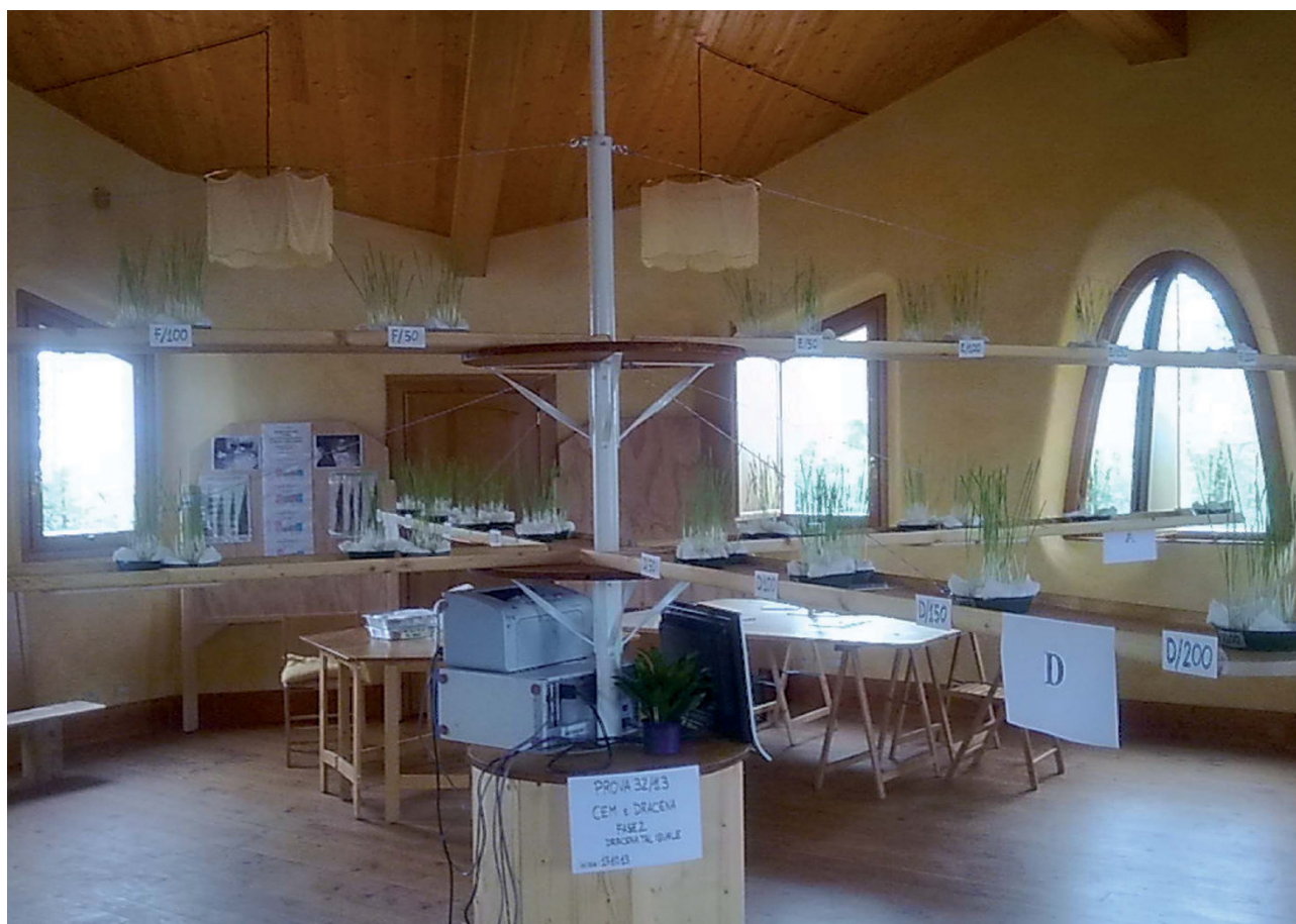
Dispositivo a braccia rotanti per mantenere l'illuminazione costante durante le prove di crescita delle plantule. Al centro la postazione "ufficio".
