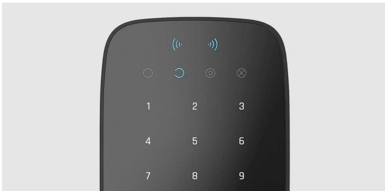
Vous pouvez utiliser le KeyPad Plus sans éclairage ambiant car le clavier dispose d'un rétroéclairage. Un signal sonore retentit lorsque les boutons sont enfoncés. La luminosité du rétroéclairage et le volume du clavier sont réglables dans les paramètres. Si vous ne touchez pas le clavier pendant 4 secondes, le
