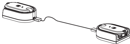
Clonage de radio au moyen d'un chargeur simple
