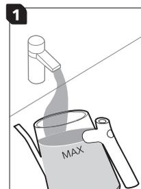
Bis zur "MAX"-Linie Wasser einfüllen.
