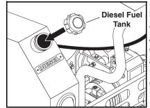
CAUTION: Do not confuse diesel fuel and gasoline when filling tanks. Keep proper fuel in proper tanks. ATTENTION: Ne pas confondre du carburant diesel et l'essence au moment de remplir les réservoirs. Garder le carburant approprié dans des réservoirs appropriés.
