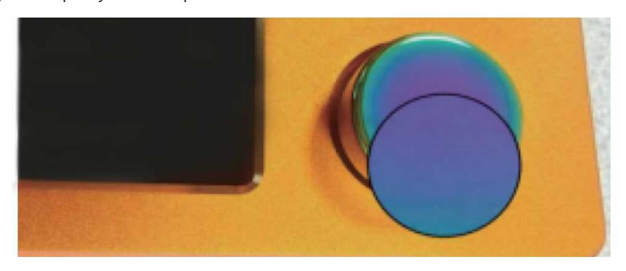
(8)由于带灯旋钮的结构设计特点,带灯编码器会在旋钮外圈出现光晕现象,属于产品设计特色。
