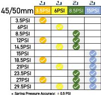
15PSI SPRING PRE-INSTALLED IN P3
