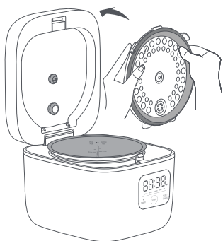
a. 内盖卡扣插入小饭煲内盖卡槽后，轻轻推入
