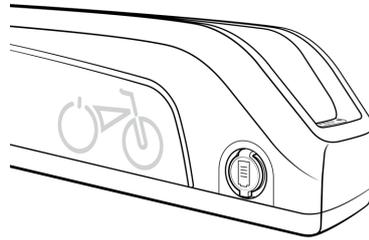
Port de charge avec cache en caoutchouc en place
