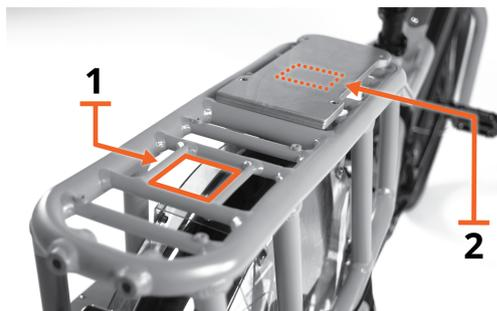
Pare-brise Thule Yepp sur le porte-bagages arrière du RadWagon. Sur cette photo, l'une des plateformes de chargement en bois est retirée afin que vous puissiez voir un pare-brise Yepp exposé (1). L'autre pare-brise Yepp (2) se trouve sous la plateforme de chargement en bois restante.
