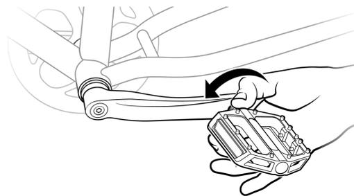
Enfilez doucement la pédale de gauche sur la manivelle gauche à la main, en tournant dans le sens inverse des aiguilles d'une montre.
