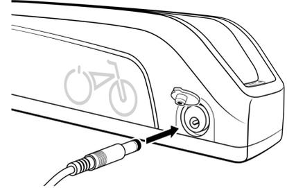
Port de charge, cache ouvert, avec fiche de sortie du chargeur positionnée pour l'insertion
