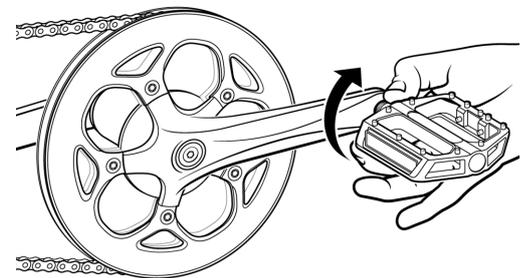
Enfilez doucement la pédale de droite sur la manivelle de droite à la main, en tournant dans le sens des aiguilles d'une montre.
