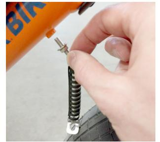
Vissez la vis à œil de l'amortisseur de direction dans le tube diagonal d'au moins 5 mm. Fixez avec un écrou de verrouillage.
