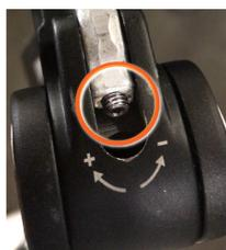
Écrou de réglage de couple du levier
