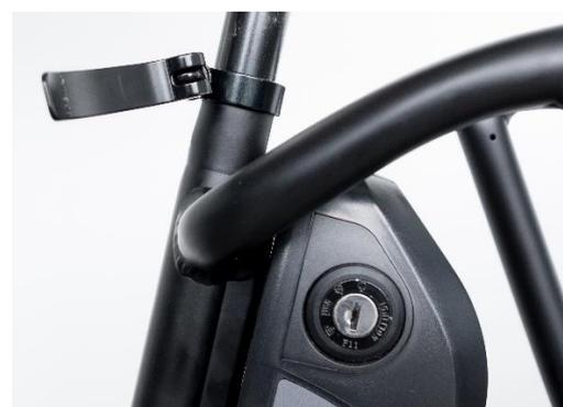
**Étape 9 : confirmez avant chaque sortie que la batterie est bien verrouillée sur le cadre du RadRunner avant de rouler.**
