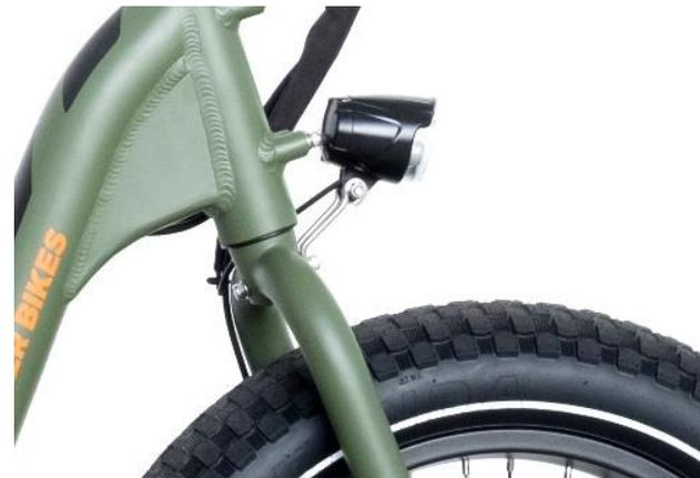
**Étape 6 : vérifiez le mécanisme de serrage rapide de la roue avant.** Confirmez que la roue est bien en place dans les pattes de la roue avant et que le mécanisme de serrage rapide est complètement et parfaitement fixé.
