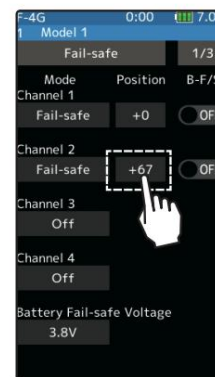
Réglage de la position Fail-Safe Tout en maintenant la molette ou la gâchette, appuyez sur le bouton de position Fail-Safe.
