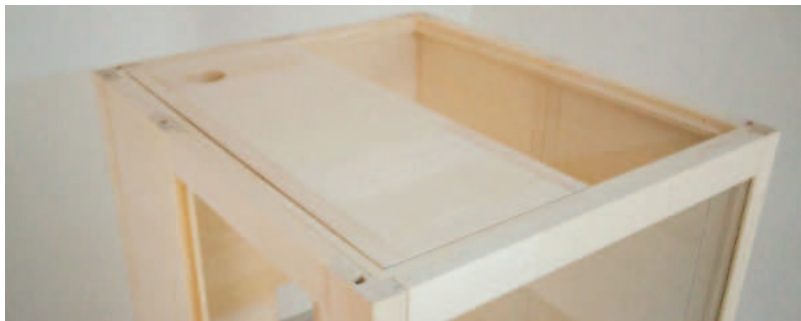
Fig. 14: Inserção dos elementos de teto da frente
