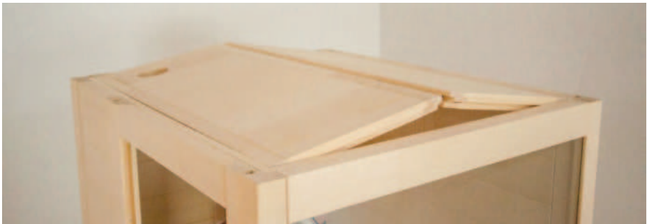
Abb. 15: Befestigen der Dachelemente
