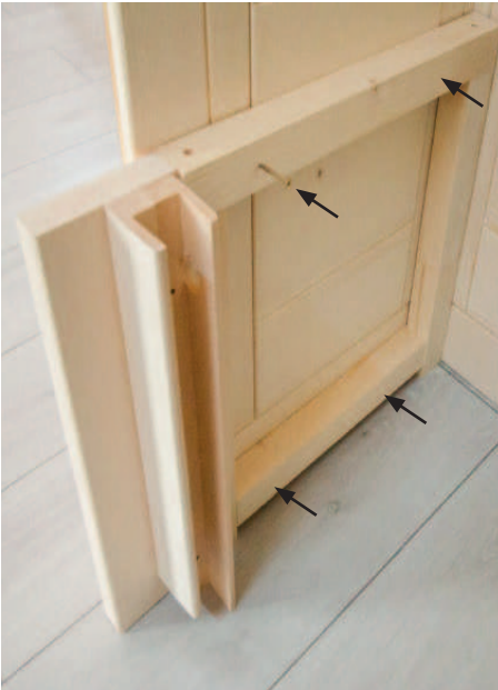
Fig. 18 : Monter les supports du banc
