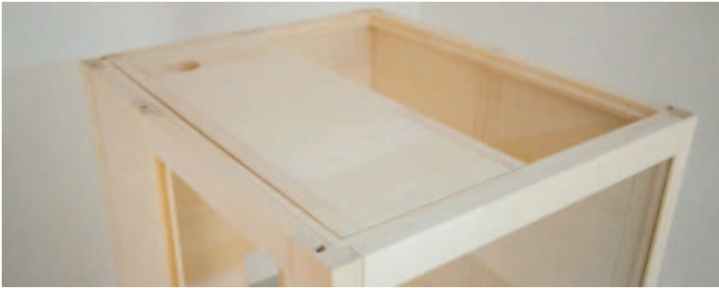
Afb. 14: Plaatsen van dakelementen voorzijde
