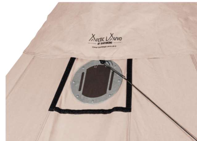
Hormiläpiviennin läppä voidaan avata ja sulkea. Metallinen rengas pitää kankaan riittävän kaukana hormista.
