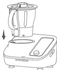
1. 將主鍋底座垂直對準主機上的卡槽，把手沖向主機正面方向同時向下按壓主鍋，聽到「咔」聲後確定主鍋已經與主機充分完全鎖合。
