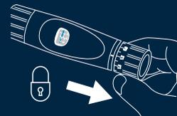
Nach Beendigung des Einsatzes drehen Sie den Einstellwert auf den kleinsten Wert zurück und legen den Drehmomentschlüssel zum Schutz vor Beschädigung und Verschmutzung wieder in die Kunststoffbox.
