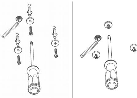
2. Fijar la base de la luminaria introduciendo los tornillos en los orificios y girando para asegurarlos.
