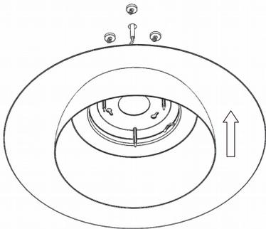
3. Una vez ubicados los tornillos en los orificios, terminar de atornillar los tornillos para fijar la base, dejando pasar el cable de alimentación por el centro.
