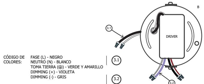
4. Pase el cable eléctrico de la luminaria por el antitirón del florón (4.1) y conéctelo en los cables negro y rojo del driver (4.2), respetando el código de colores. Encajar el florón en la pieza de sujeción y apretar los tornillos de seguridad (4.3). Apretar el tensor del cable situado en el florón.
