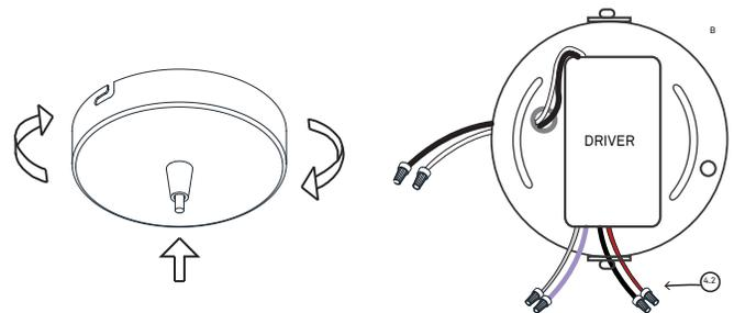
5. Encajar el canope en la pieza de sujeción y apretar los tornillos de seguridad. Apretar el tensor del cable situado en el florón.
