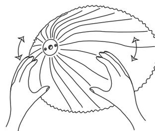
5. Para finalizar, enroscar el embellecedor hasta que queden bien fijada la tulipa al soporte. **ATENCIÓN!** No es necesario enroscar hasta llegar al tope, esto podría deformar el diseño de la luminaria.
