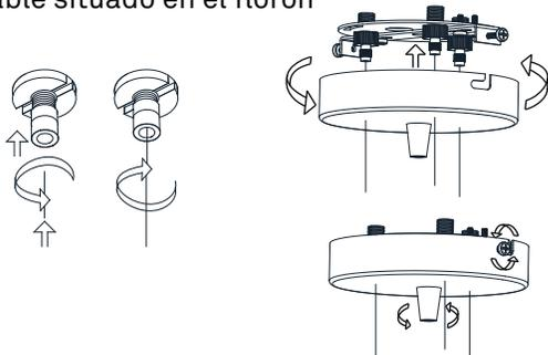
4. Aflojar la tuerca de seguridad e introducir el cable de acero. Apretar la tuerca de seguridad. Para sacar el cable del tensor aflojar la tuerca, empujarla hacia arriba y tirar del cable.
