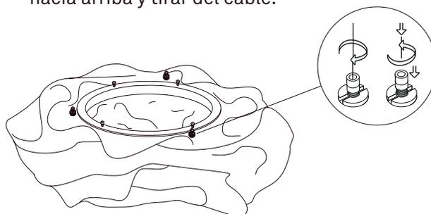
5. Encajar la tulipa en el soporte, girándola hasta que haga tope al introducir los tornillos de enganche en las ranuras del florón. Apretar la rosca de los tornillos de enganche para asegurar el conjunto. Encajar el florón en la pieza de sujeción y apretar los tornillos.
