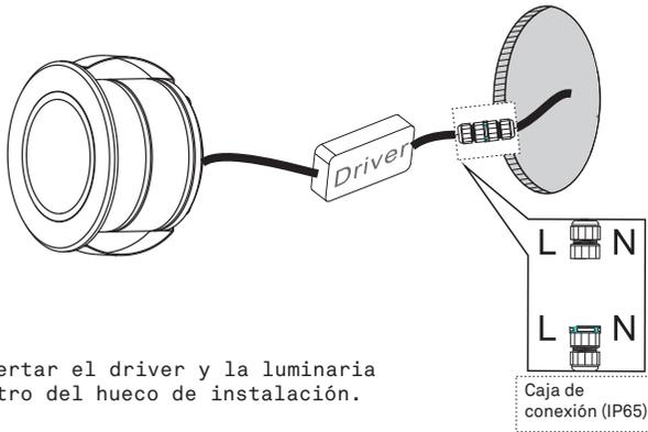
Insertar el driver y la luminaria dentro del hueco de instalación.
