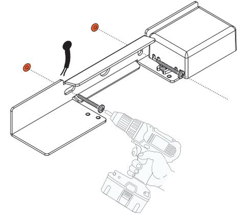
Fijar la pieza de sujeción al muro insertando los taquetes y tornillos (incluidos).
