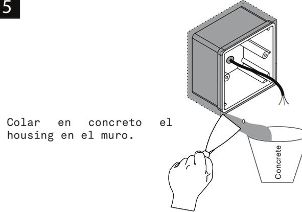
Colar en concreto el housing en el muro.
