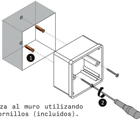
Fijar la pieza al muro utilizando taquetes y tornillos (incluidos).
