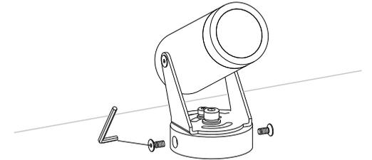
Fijar la luminaria con los tornillos laterales.
