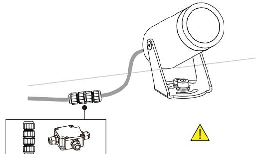
Asegurarse de usar la conexión a prueba de agua.
