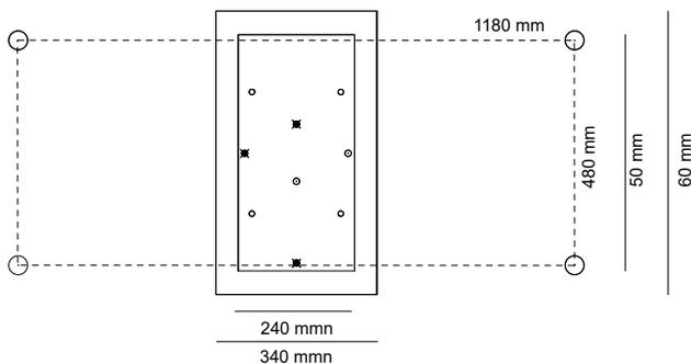
1.2 Sujetar cruceta utilizando tornillos (incluidos).
