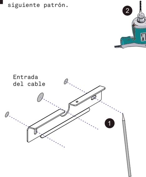
**3** Fijar la pieza al muro insertando taquetes y tornillos (incluidos).
