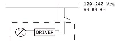
Conectar cables de alimentación a línea de instalación eléctrica.
