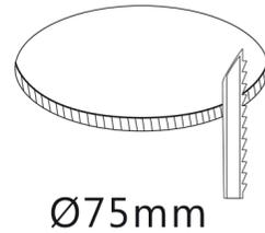
Realizar hueco de instalación en el techo.
