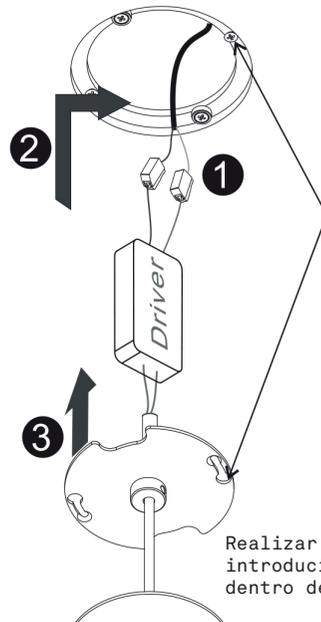
Realizar conexión e introducir el driver dentro del plafón.
