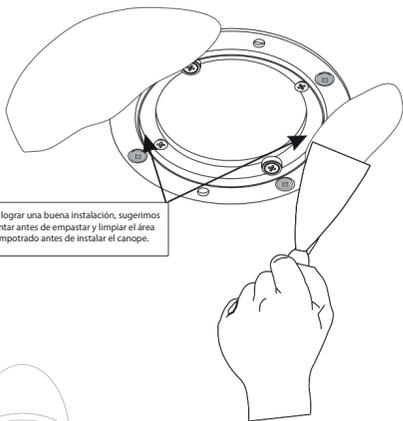
Para lograr una buena instalación, sugerimos encintar antes de empastar y limpiar el área de empotrado antes de instalar el canope.
