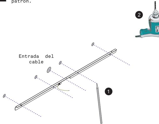
**3** Fijar la pieza al muro insertando tornillos y taquetes (incluidos).
