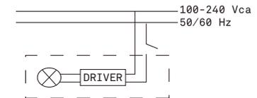
Conectar cables de alimentación a línea de instalación eléctrica.
