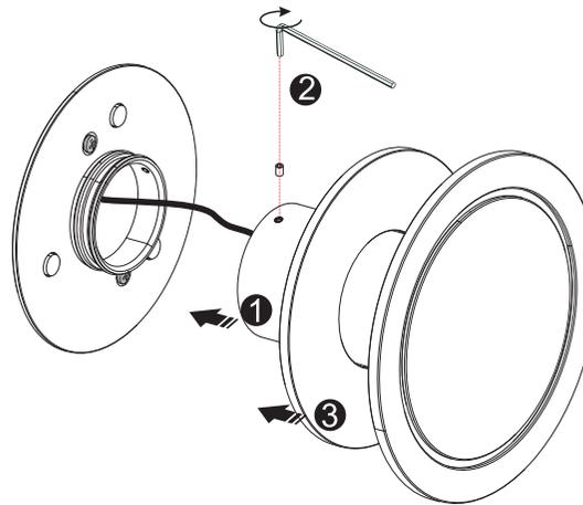
Insertar y fijar la luminaria girando los tornillos.
