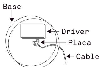
2.2 Vuelva y apriete los tornillos de la placa asegurando el largo del cable.
