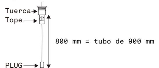
5.2 Revisar estrictamente que la tuerca se coloque sobre el recubrimiento plástico del cable, para no generar daños al ejercer presión.
