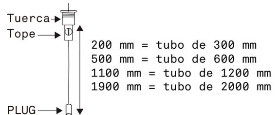
5.2 Revisar estrictamente que cada tuerca se coloque sobre el recubrimiento plástico de cada cable, para no generar daños al ejercer presión.
