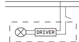
Conectar cables de alimentación a línea de instalación eléctrica.
