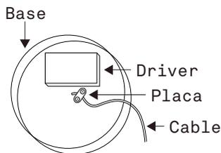
2.2 Vuelva y apriete los tornillos de la placa asegurando el largo del cable.
