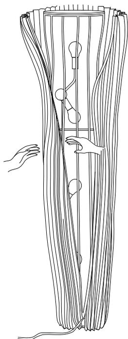
3. Debido a las características de la lámpara, el correcto agarre sería del modo en el que se ilustra en la siguiente imagen para evitar aplastamientos.
