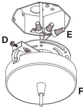
2. Encajar el florón en la pieza de sujeción y apretar los tornillos de seguridad.
