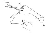
2. Separe el puente de fijación parte B de la base de la base de la luminaria parte A.
