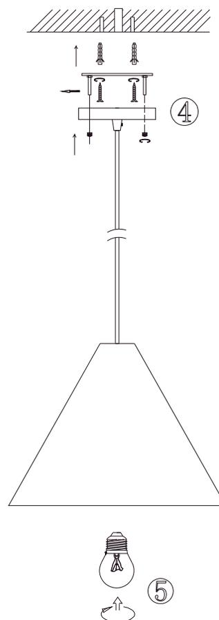
5. Enroscar en el interior de la luminaria en el socket la lámpara.
