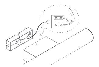
3. Fijar la luminaria al muro.3.1 Ensamblar ambas partes de la luminaria, como se muestra en la siguiente imágen.
