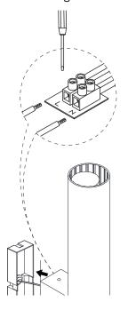
3. Ensamblar ambas partes de las luminarias, como se muestra en la siguiente imágen.
