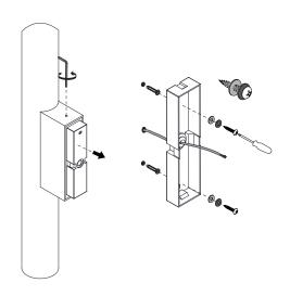
2. Conectar la parte de la luminaria con el LED integrado, como se muestra en el diagrama.
