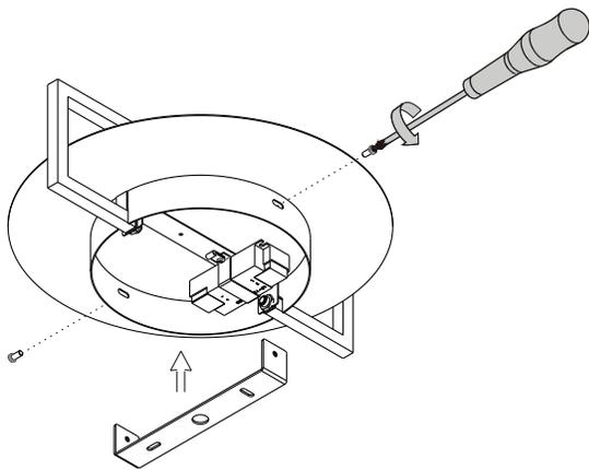
2. Realizar los orificios e introducir los taquetes, para posteriormente fijar la cruzeta atornillando.
