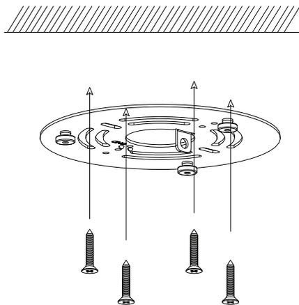
3. Ensamblar el canope de la luminaria, así como se muestra en la siguiente imagen.
