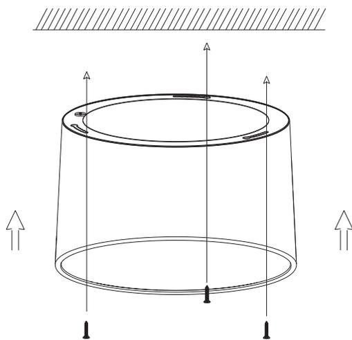
3. Ensamblar ambas partes de las luminarias, como se muestra en la siguiente imagen.
