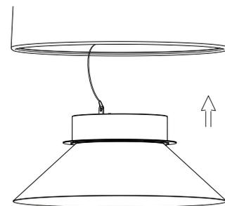
2. Conectar la parte de la luminaria con el LED integrado, así como se muestra en el diagrama.
