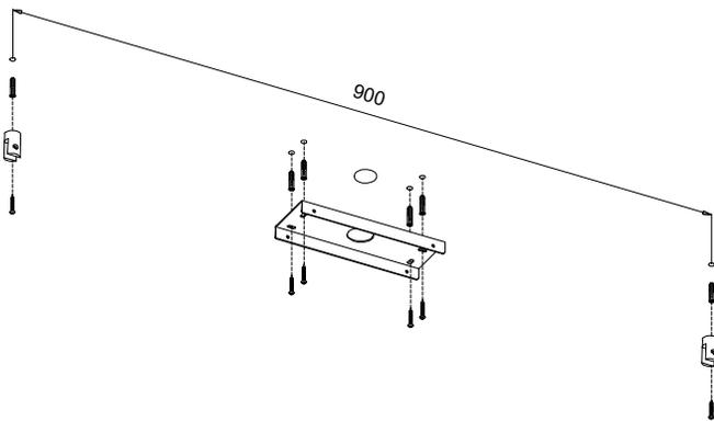
3. Ajustar la altura del cable de la luminaria a la altura deseada.
