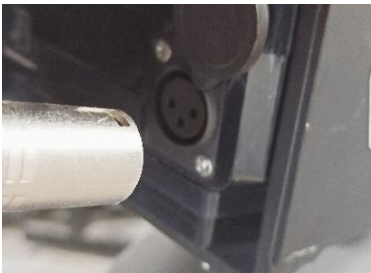
Conector de carga en batería
