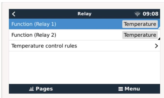
Jeder Temperatursensor kann zur Steuerung des Relais verwendet werden.
