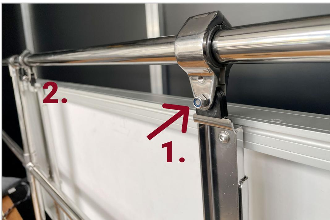
5. Verstellbare Mittelstrebe danach an die Unterstrebe der Reling montieren (dazu Paneel leicht nach außen drücken); jeweils eine Kunststoff Unterlegscheibe ober- und unterhalb der Lasche einsetzen
