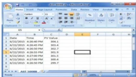
ÿ Cal Soft incluant le réglage de la température du bain et la surveillance du PV. Représentations graphiques de PV/TIME avec enregistrement de données sur 2 heures.
