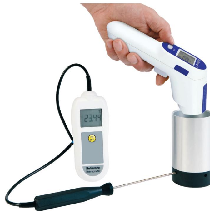
Un comparateur utilisé pour vérifier la température d'un thermomètre infrarouge RayTemp 3 par rapport à un thermomètre de référence.
