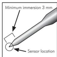
Appliquez la pointe de la sonde sur la substance, le milieu ou la surface à mesurer. Le capteur est situé à l'extrémité de la sonde, par conséquent, la profondeur d'insertion minimale doit être de 3 mm.
